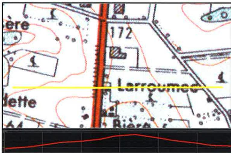
La RN 524 se trouve légèrement en dessous de la ligne de crête ; néanmoins, la pente est faible, plus que le pente ouest, au point que le terrain peut être considéré comme plat dans la moitié de sa profondeur. En l'état actuel la vue pénètre en profondeur vers l'est, bien au-delà du site.
